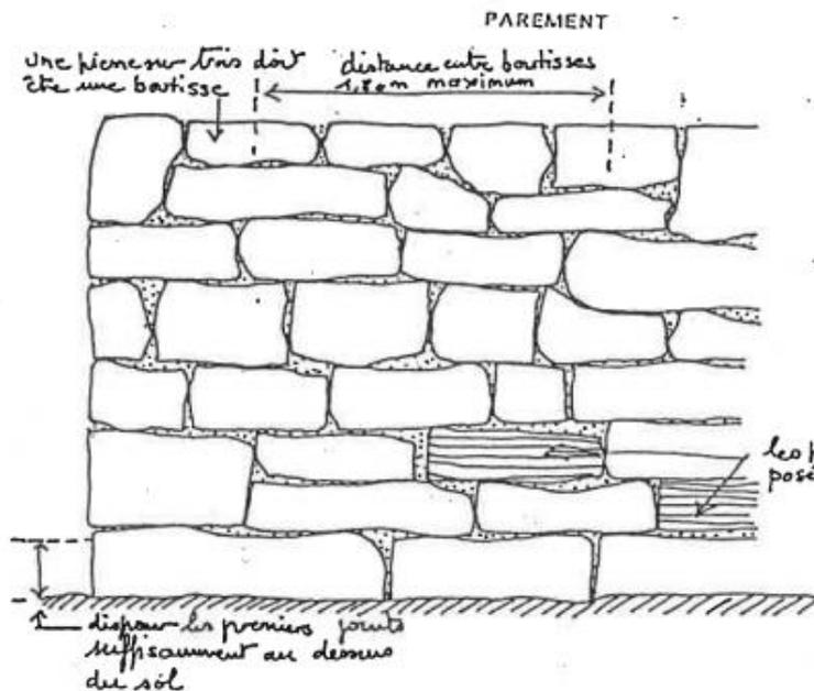
La hauteur du joint = que du remplissage visant à l'étanchéité du mur à l'eau de ruissellement ou de pluie. Chaque pierre doit être en contact en au moins trois points avec ses mitoyennes et non sur un lit de mortier.
