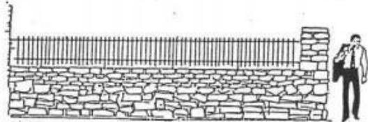
☞ mur ou muret de pierres naturelles (ou parement) surmonté d'une lisse en bois ou métallique,
